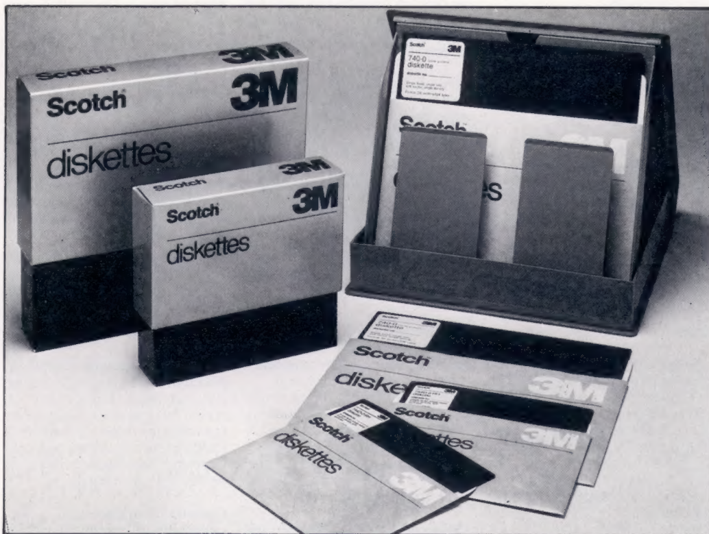
Les disquettes sont souples et rangées dans une enveloppe protectrice carrée.
